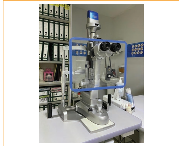
Figura 1. Separador plástico para lámpara de hendidura, fácil de hacer y adaptar para los diferentes tipos de lámparas.
